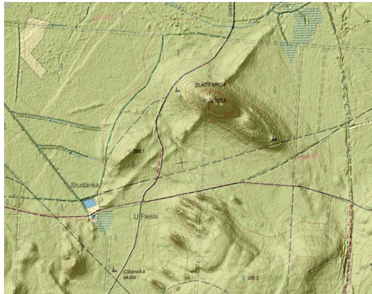
Obr. 60. Digitální model reliéfu v okolí Zlatého vrchu a pramene U Flesla na základě leteckého laserového skenování (LIDAR 5G). Zdroj: Český úřad zeměměřičský a katastrální, obarvený stínovaný reliéf, převýšení 10×, http://ags.cuzk.cz/dmr/# .
