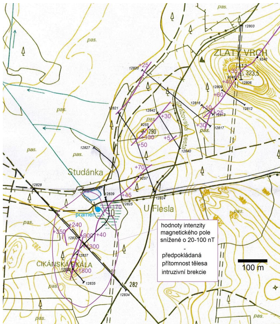
Obr. 62. Situace geomagnetických profilů a průběh těles vulkanitů na lokalitě 5.5. Břehyně – pramen U Flesla. Vulkanity jsou znázorněny fialovou barvou, tenčí fialovou čarou je vynesena kontura tělesa intruzivní brekcie. Tenkými černými čarami jsou znázorněny geomagnetické profily s číselným označením krajních bodů, v místech zaznamenaných anomálií magnetického pole je uvedena číselná hodnota amplitudy anomálie oproti normálovému poli v nT. Vyznačeny jsou též terénní dokumentační body, na něž je odkazováno v textu.
